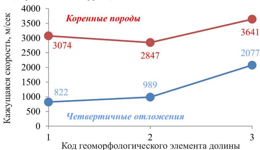
Рисунок 4. Графики субширотной изменчивости в долине «Туймааде» средних значений кажущихся скоростей продольных преломленных волн в мёрзлой толще четвертичных отложений и коренных породах осадочного генезиса (составлено автором)
