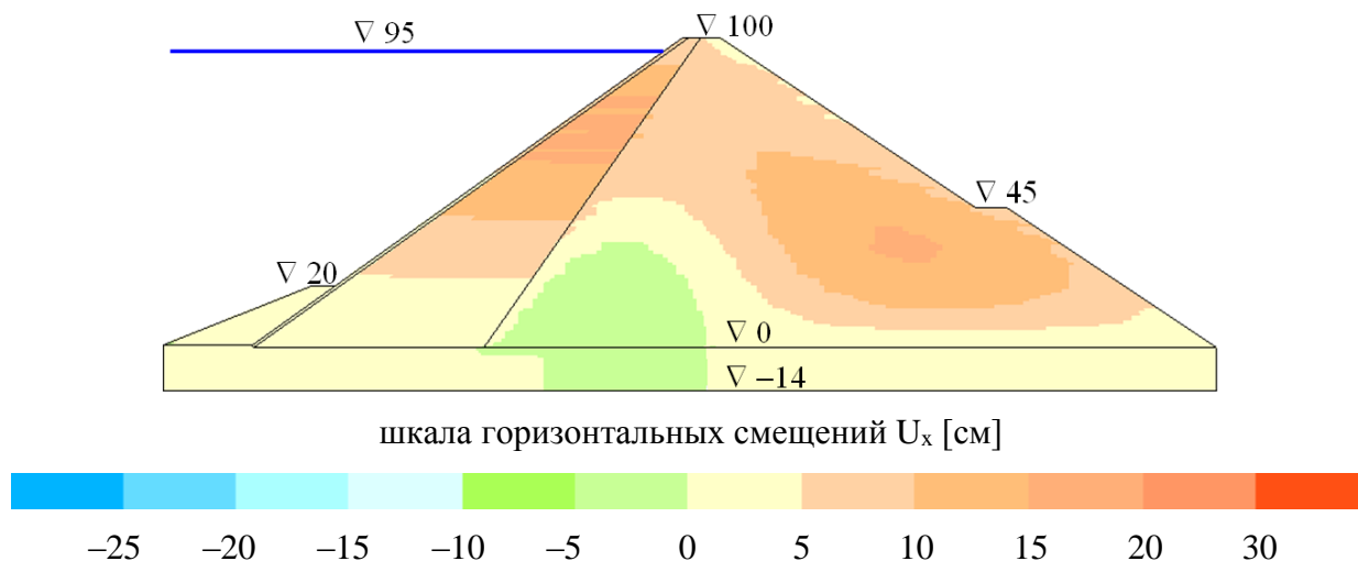
Рисунок 10. Смещения плотины в варианте 3В (получены автором)
