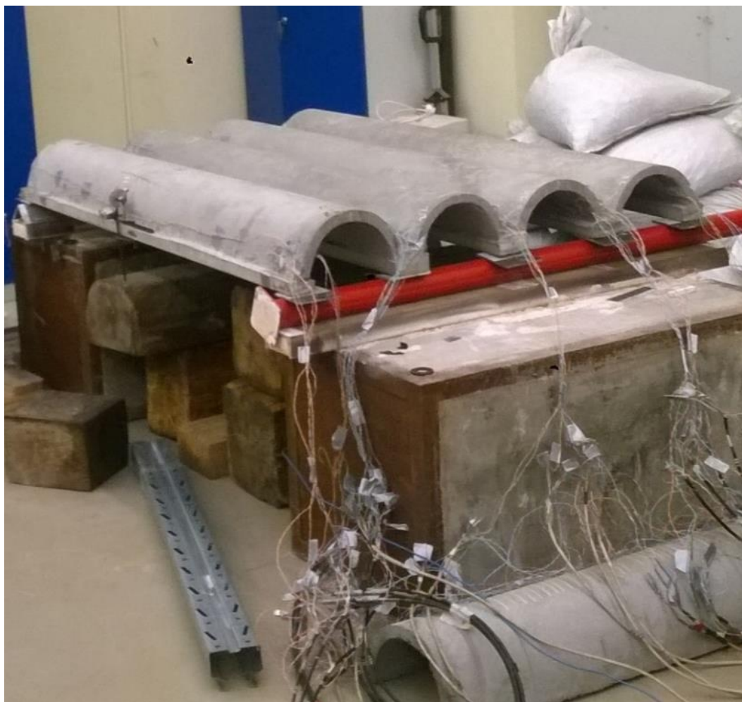
Рисунок 7. Модель многоволновой плиты перекрытия из сталефибробетона при подготовке к испытаниям статическими нагрузками (фото автора)
