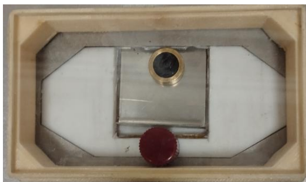
Рисунок 9. Установленный образец в измерительном отсеке (разработан авторами)
