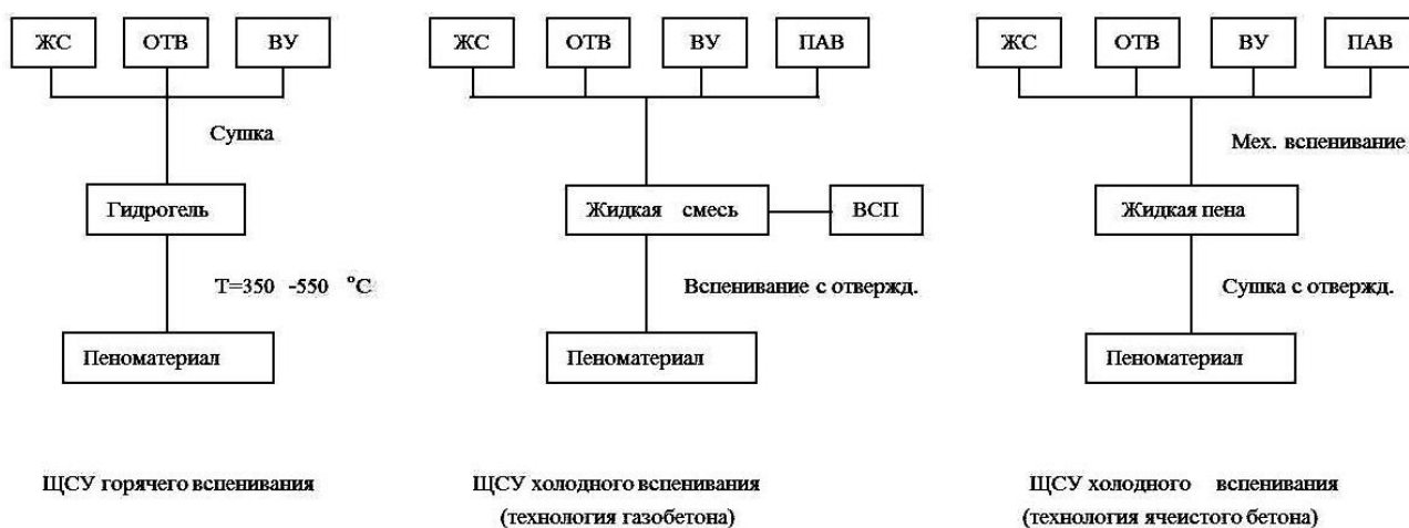
Рисунок 1. Схемы получения щелочносиликатных утеплителей (ЩСУ) (составлено автором)
