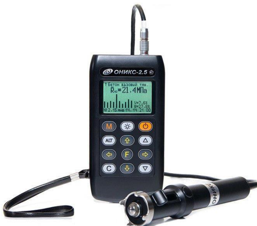
Рисунок 5. Прибор для измерения прочности бетона ударно импульсным методом ОНИКС – 2.5 (источник https://market.yandex.ru/offer/-aA4Lv6AlP3VSFFhrzY6Sg?clid=932&lr=197 )
