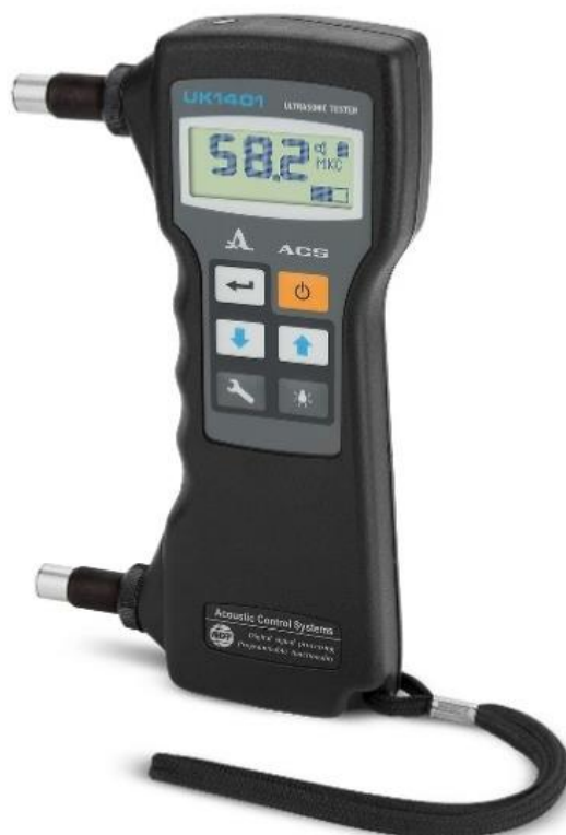
Рисунок 8. Прибор для измерения прочности бетона ультразвуковым обследованием UK1401 (источник https://novosibirsk.tiu.ru/p11675313-ultrazvukovoj-tester-betona.html )
