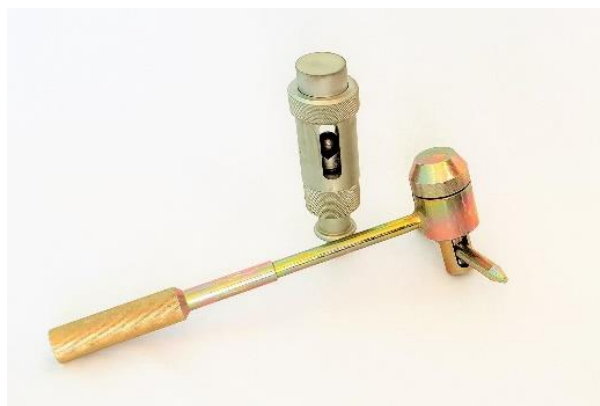
Рисунок 7. Прибор для измерения прочности бетона методом пластических деформаций Молоток Кошкарлова (источник https://informbuilding.ru/molotok-kashkarova-princip-dejstviya-i-instrukciya-po-primeneniyu-opredelenie-prochnosti-betona-etalonnyim-sklerometrom-preimushhestva-i-nedostatki/ )
