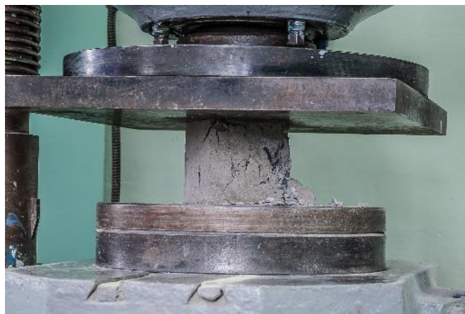
Рисунок 1. Испытание выбуренного образца бетона на прессе (источник https://beton-house.com/izdeliya/stenovoye/bloki-gazobetonnye-gost-107 )
