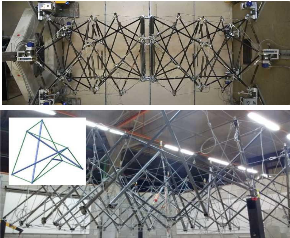
Рисунок 7. Развертываемая сетка, предложенная Gomez-Jauregui et al. и его базовый модуль (фото любезно предоставлено Валентином Гомес- Хауреги, Университет Кантабрии) [6; 11]
