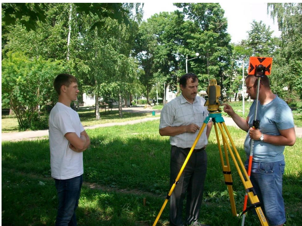
Рисунок 1. Установка электронного тахеометра в «рабочее положение» (выполнен авторами)
