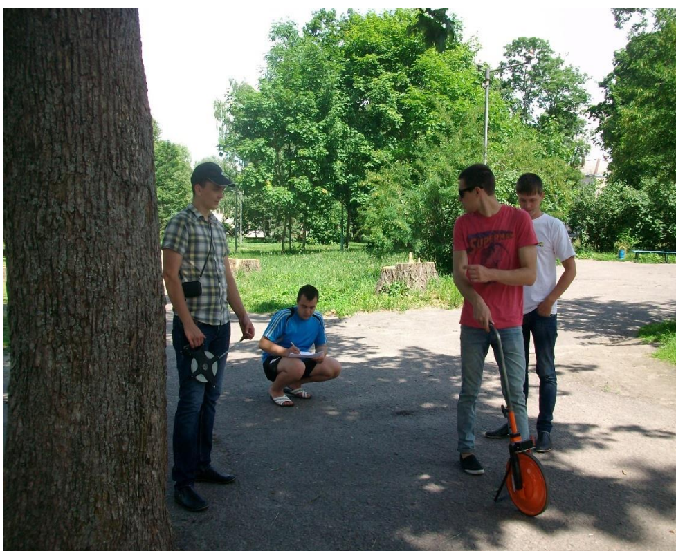
Рисунок 2. Измерение длины существующих дорожек парка курвиметром — дорожным колесом (выполнен авторами)
