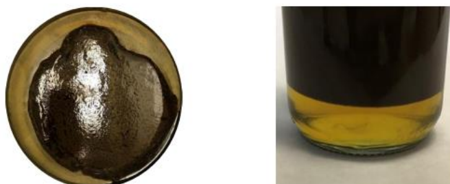
Рисунок 3. Эмульсия кислоты и нефти
