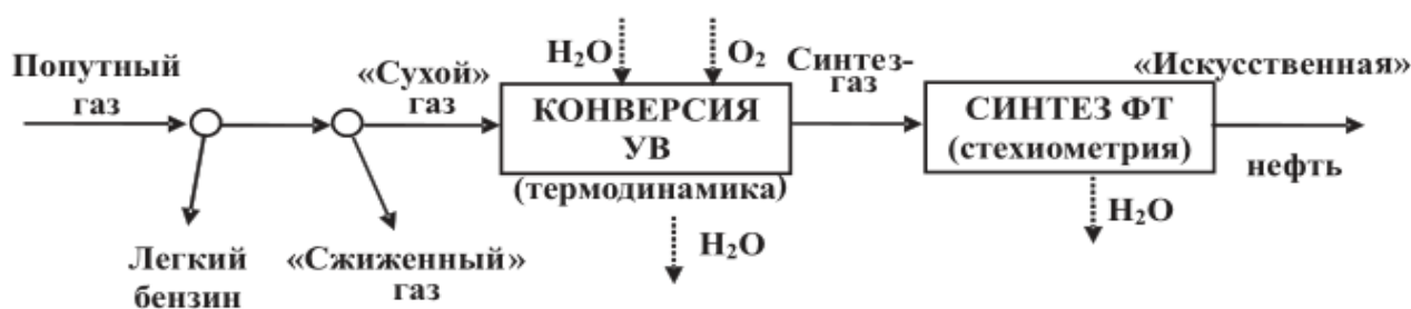
Рисунок 4. Переработка ПНГ на основе химических процессов GTL [8]
