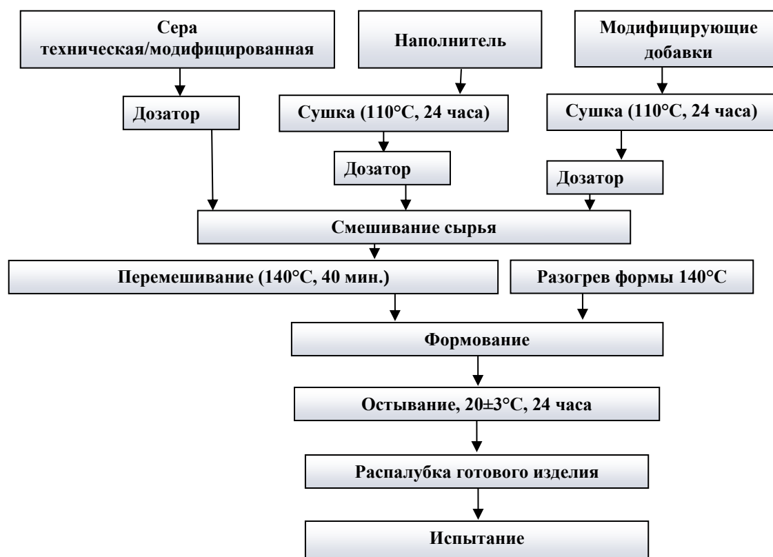
Рисунок 1. Технологическая схема изготовления серобетонных образцов (составлено авторами)
