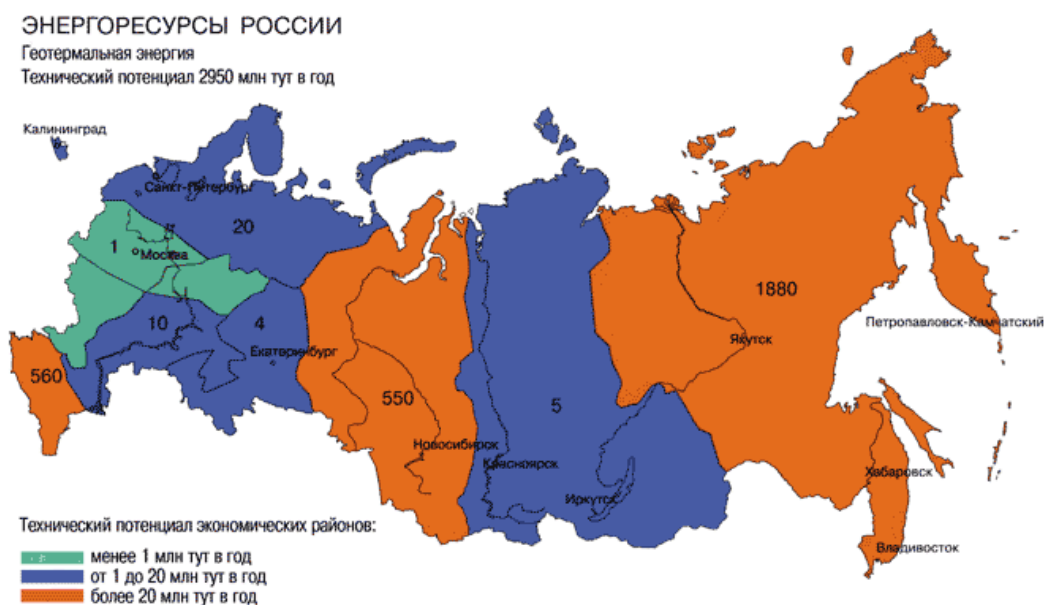
Рисунок 9. Карта геотермальных ресурсов Российской Федерации (источник: экономика и финансы ТЭК: учебник / Эскиндаров М.А., под ред., Шаркова А.В.)
