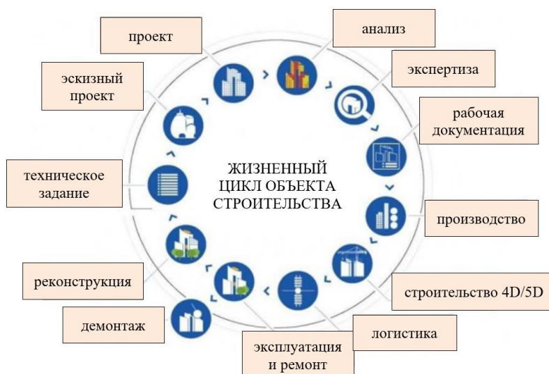
Рисунок 1. Жизненный цикл объектов капитального строительства [4]
