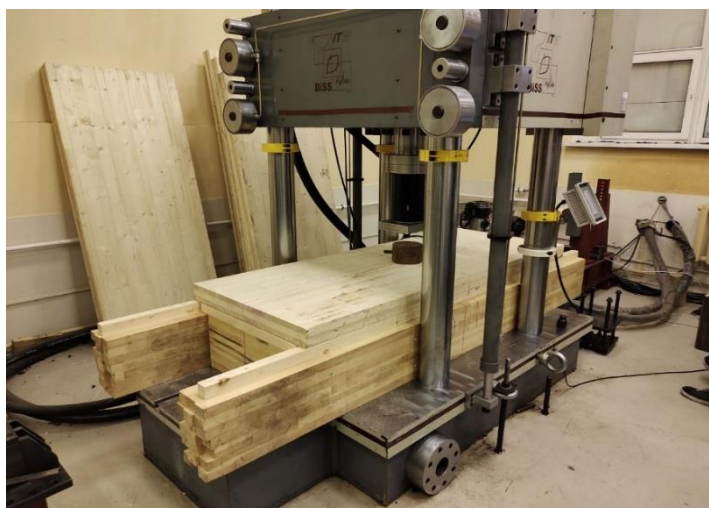
Рисунок 1. Уложенная на опоры панель в испытательной машине (фото авторов)
