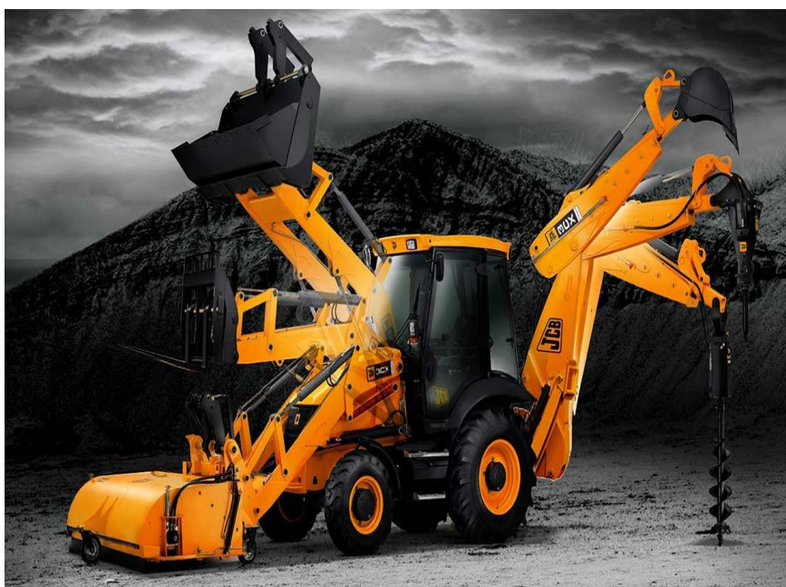
Рисунок 1. Пример оснащения рабочим оборудованием многофункциональной техники (взято из монографии, выполненной авторами) [4, с. 108]
