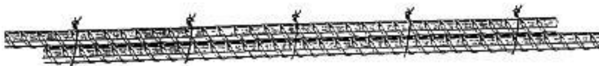
Рисунок 1. Соединение стержней продольной арматуры внахлестку (взято из СП 70.13330.2012)
