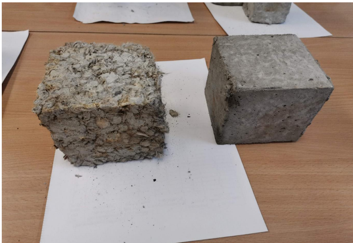
Рисунок 1. Внешний вид образцов кубиков размерами 70x70x70 мм: слева – из смеси, армированной полиэтиленовыми гранулами (фибрами) на омагниченной воде затворения; справа – без добавки фибр, изготовленный на омагниченной воде затворения (выполнено авторами)
