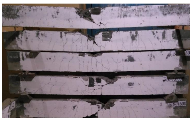
Рисунок 15. Характер разрушения балок в ходе испытания 1
