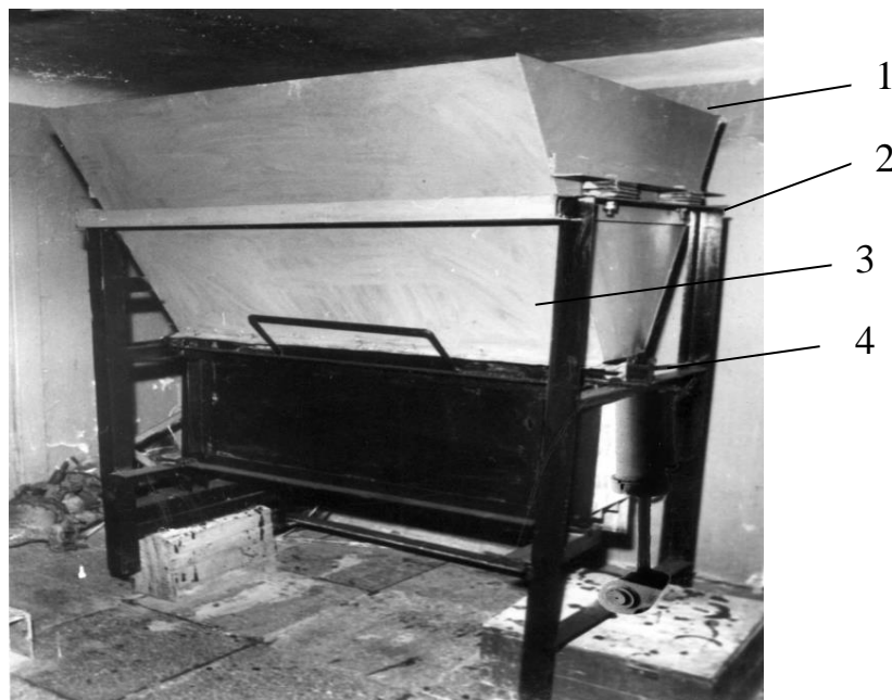
1 — бункер; 2 — рама; 3 — откидная стенка; 4 — гидроцилиндр
