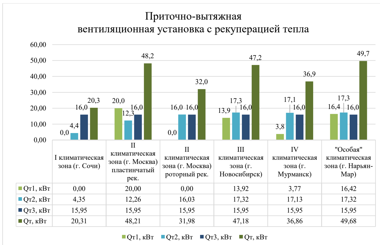
Рисунок 15. Сводный анализ расчетных затрат энергии на обработку воздуха в приточно-вытяжной вентиляционной установке с рекуперацией тепла (разработано авторами)
