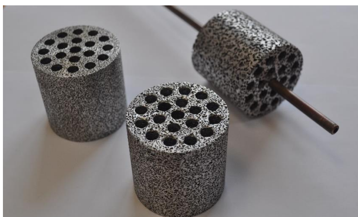
Рисунок 2. Образцы пористых вставок из алюминия (фото авторов)
