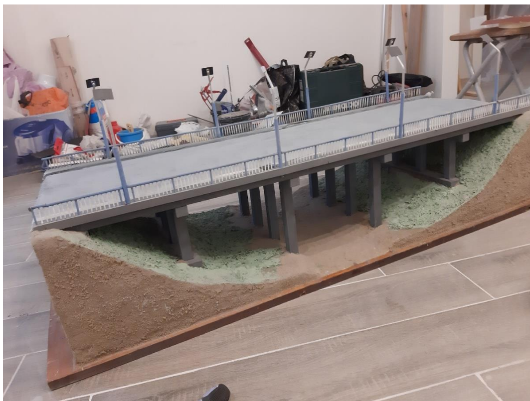
Рисунок 1. Модель путепровода с упругими фундаментами (разработана авторами)
