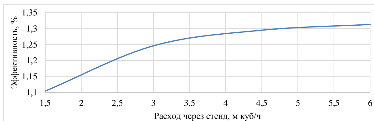
Рисунок 3. График зависимости эффективности использования завихрителя от значения входного расхода Q (составлено авторами)
