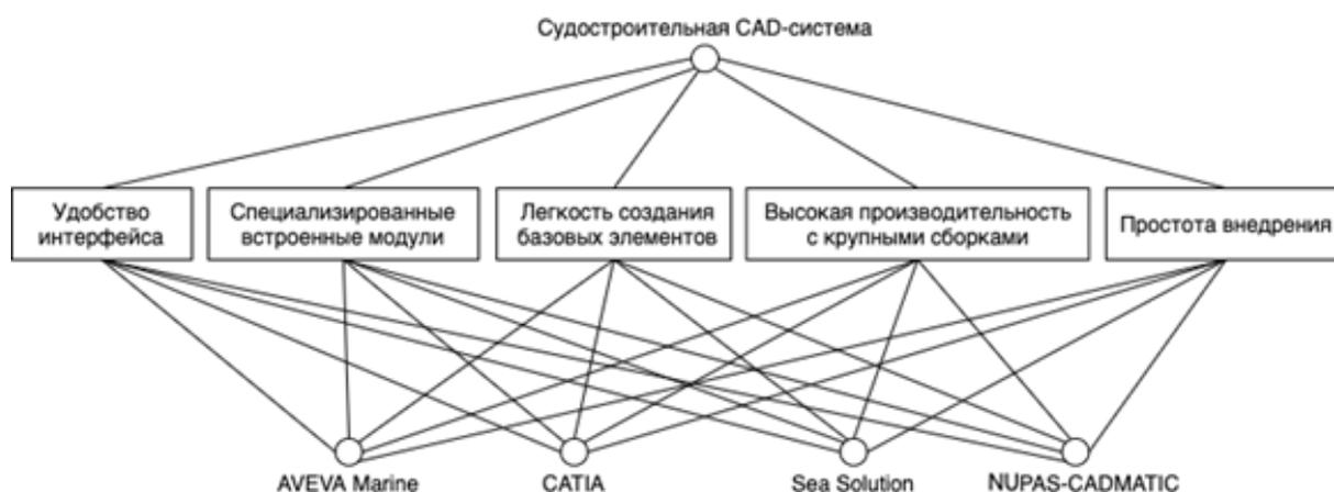
**Рисунок 1.** Иерархическая структура задачи выбора судостроительной CAD-системы (составлена авторами)
