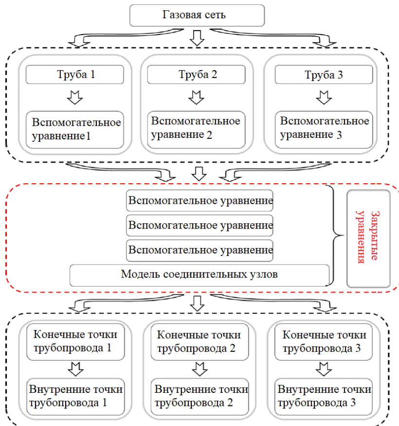
Рисунок 4. Принципиальная схема метода введения дискретизированных уравнений газопровода для решения системы (составлено авторами)
