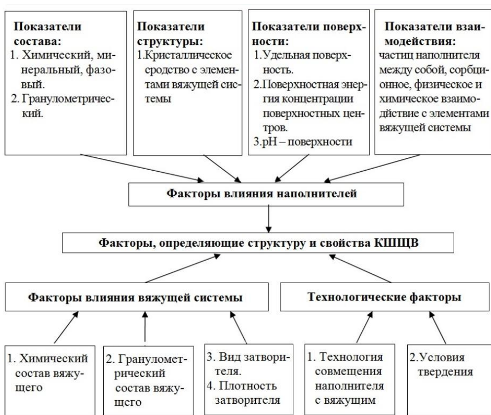
Рисунок 1. Система факторов, определяющих структуру и свойства КШЩВ [3]
