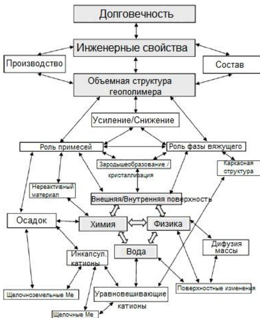
Рисунок 2. Диаграмма зависимостей между научными и техническими аспектами долговечности геополимеров по данным 2
