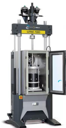
Рисунок 1. Установка для испытаний на усталость ПКМ (рисунок заимствован из паспорта оборудования)
