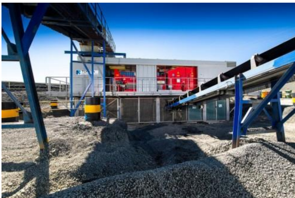
Рисунок 2. Высокпроизводительный и эффективный сортировщик шлама TOMRA COM XRT 2.0 (по материалам экологической выставки в г. Уфа в 2021 г.)
