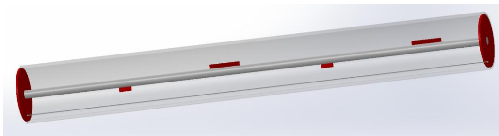
Рисунок 2. 3D-модель канала гладкого регистра (разработано авторами)
