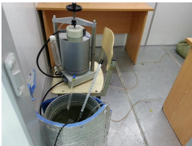
Рисунок 6. Проведение испытания по определению степени пучинистости грунта в приборе «УПГ-МГ4. Грунт» (фото выполнено авторами)
