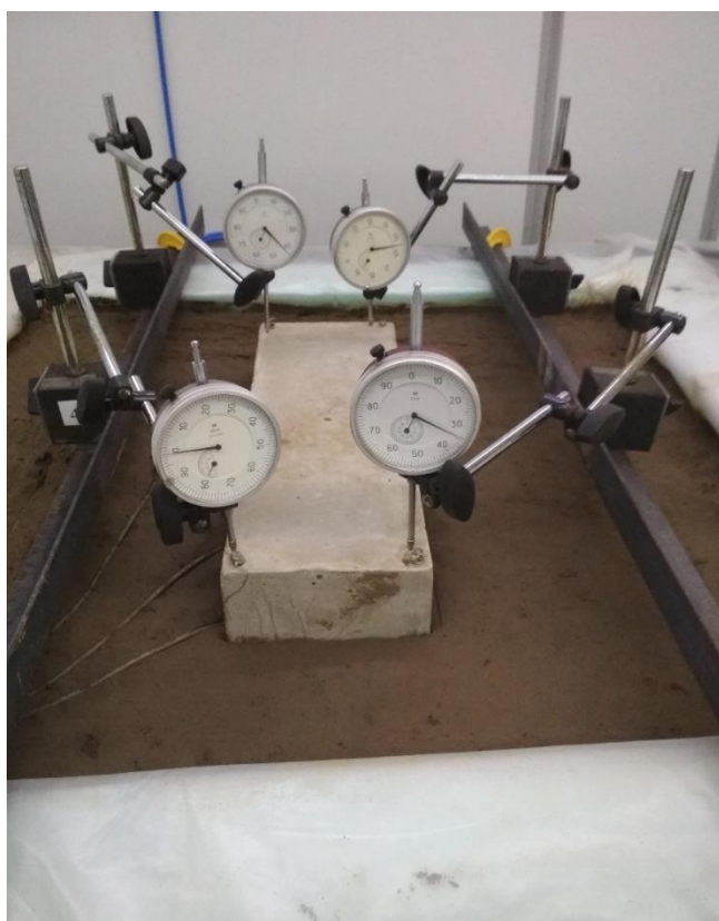
Рисунок 5. Общий вид экспериментального стенда во время проведения эксперимента в лабораторных условиях (фото выполнено авторами)
