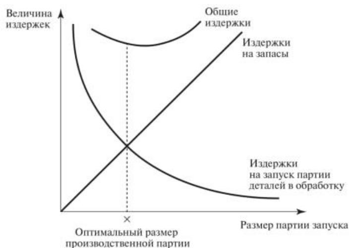
**Рисунок 1.** Графическое определение оптимального размера партии
