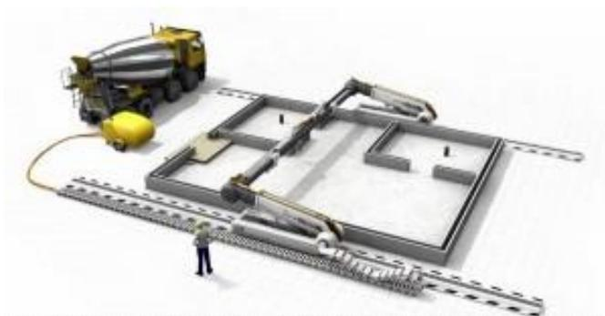
**Рисунок 1.** Строительный 3D-принтер
