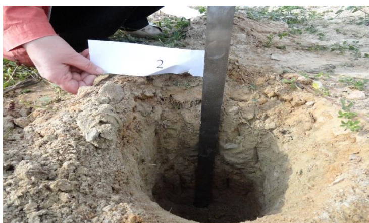
Рисунок 3. Определение толщины слоя основания из цемента-грунтовой смеси (выполнено авторами)
