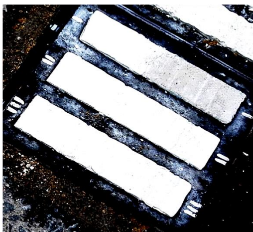
Рисунок 4. Образцы разметочного материала на трассе испытательного полигона после испытаний: I – образец «Кратер»; II – состав 1; III – состав 2 (фото автора)
