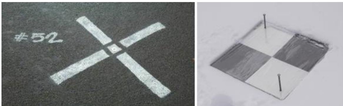
Рисунок 5. Опорные точки (реперы) ( https://geoplys.ru/uslugi/aerosemka/amp/ )
