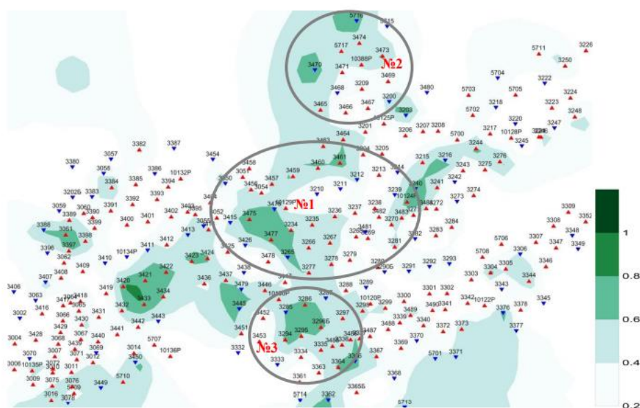
Рисунок 4. Выделение участков месторождения для прогнозирования эффективности ГТМ с учетом неоднородности по проницаемости объекта (рисунок на основе «Технологическая схема разработки месторождения N»)
