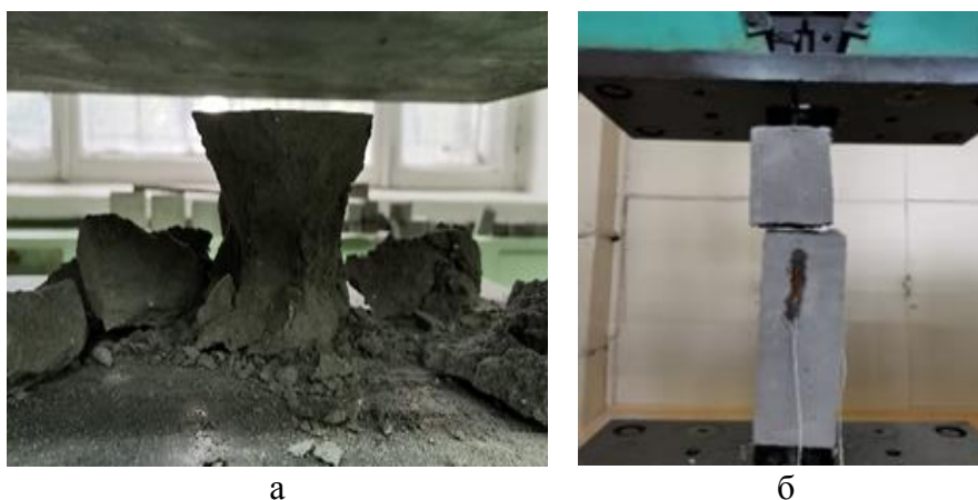
Рисунок 2. Разрушение образца при испытании: а — на осевое сжатие; б — на осевое растяжение (выполнено авторами)
