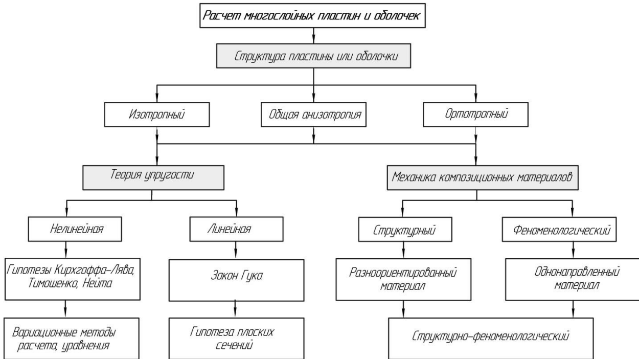
Рисунок 3. Схема расчета слоистых пластин и оболочек для многослойных конструкций (разработано авторами)
