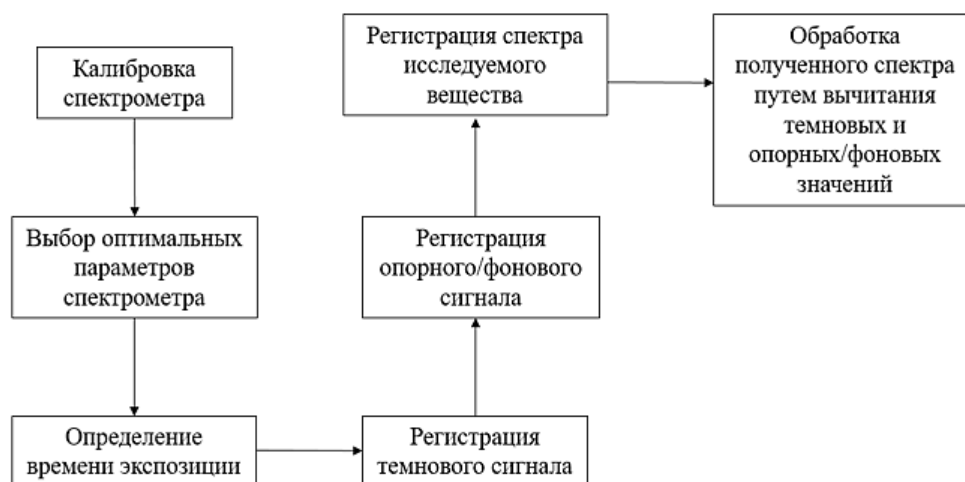
Рисунок 2. Этапы обработки спектра комбинационного рассеяния света (подготовлено авторами)
