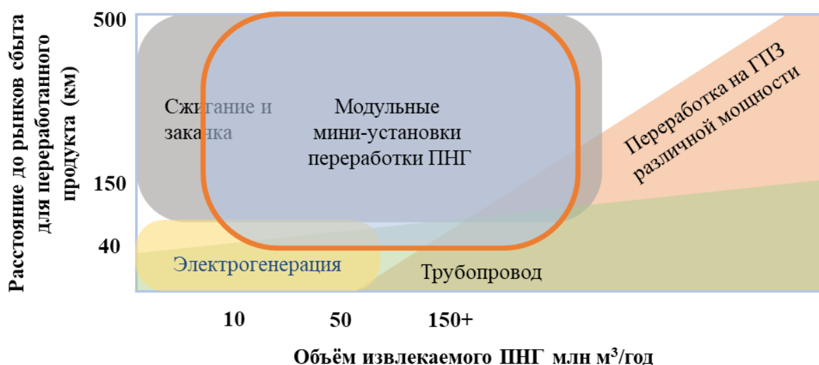
Рисунок 2. Система выбора технологий использования ПНГ в зависимости от объемов добываемого на месторождениях газа и расстояний (составлено автором)
