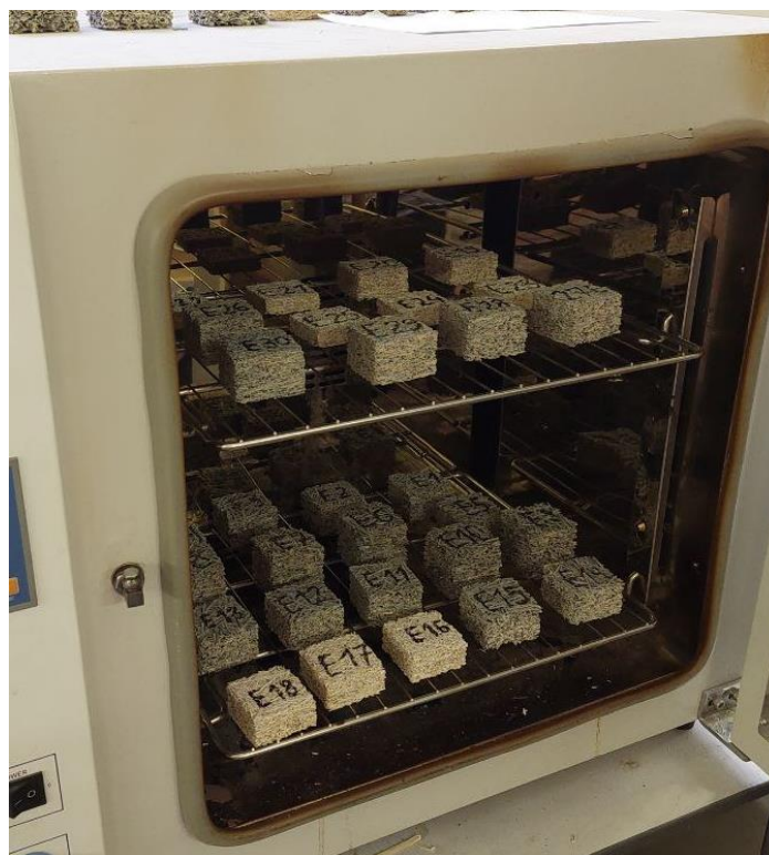
Рисунок 2. Сушка образцов фибролитовых плит в сушильном шкафу (фото авторов)
