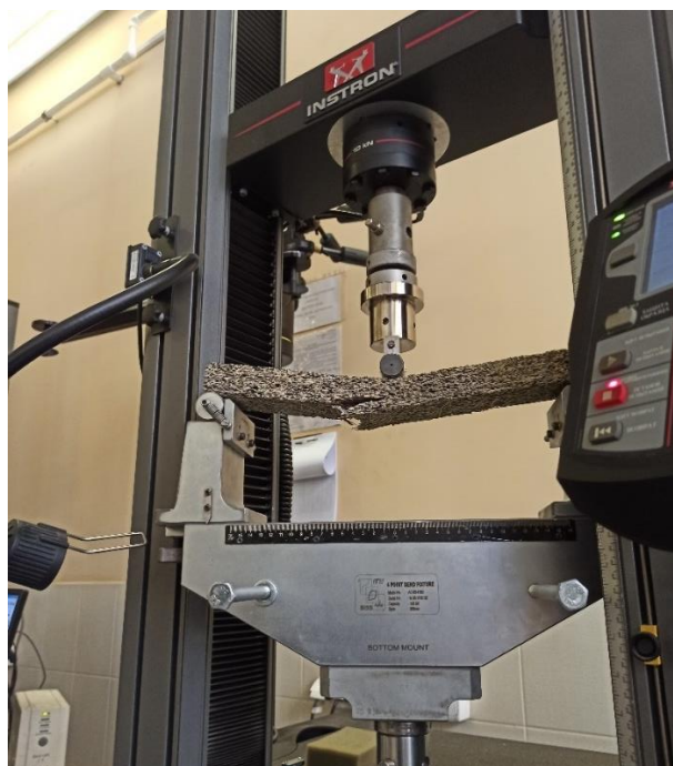
Рисунок 4. Испытания образцов фибролитовых плит на изгиб (фото авторов)
