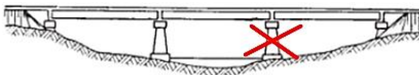
Рисунок 2. Схема обрушения опоры мостового сооружения (составлено авторами)
