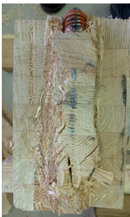
Рисунок 8. Разрушение образца после проведения испытания (фото автора)
