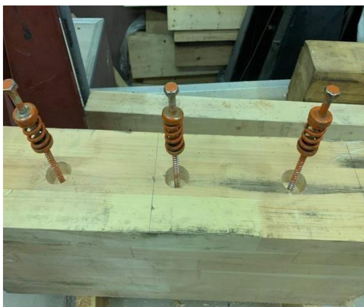
Рисунок 7. Подготовка образца к испытаниям на вдавливание (фото автора)
