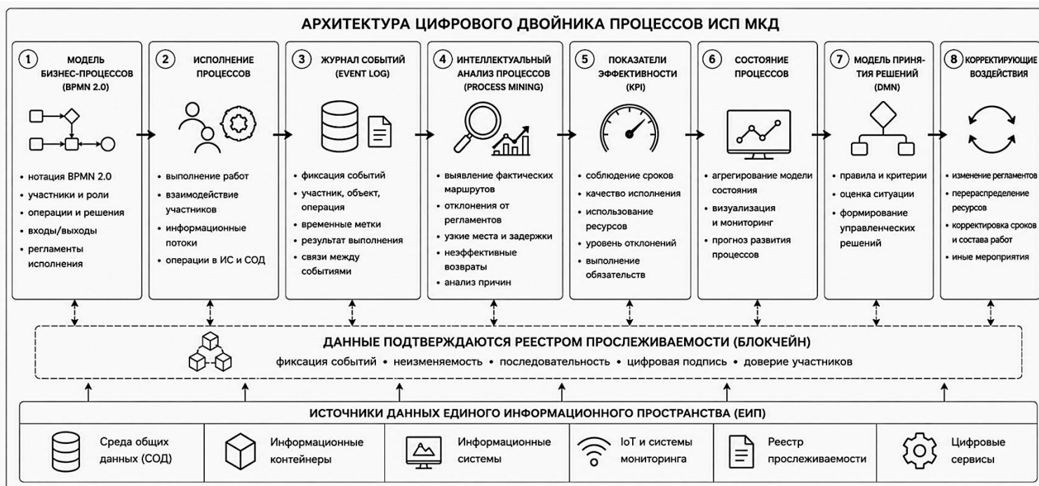
Рисунок 3. Архитектура цифрового двойника процессов ИСП МКД (составлено авторами)
