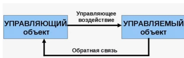
Рисунок 2. Схема управления с обратной связью [17]
