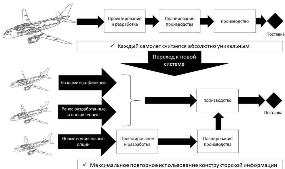
**Рисунок 4.** Трансформация подхода к проектированию и серийному производству коммерческих воздушных судов (источник: составлено автором)
