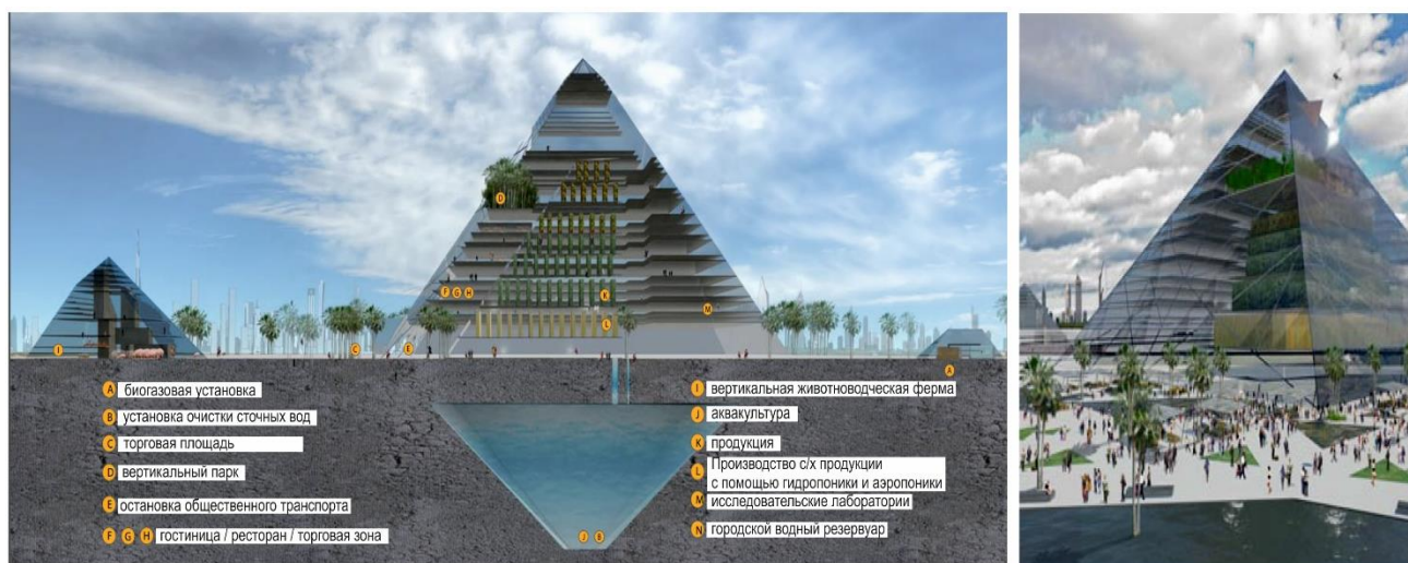
Рисунок 2. Структурная схема вертикальной фермы Pyramid Farm в городе Дубаи. Авторы: Эрик Эллинген и Диксон Деспомьер (источник: Ellingsen E., Despommier D. The Vertical Farm – The origin of a 21st century Architectural Typology. СТВУН Journal. 2008. Issue III) (переведено с англ. автором)
