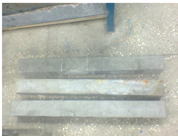
Рисунок 1. Призмы, выпиленные из образца кольцевого сечения (составлено авторами)
