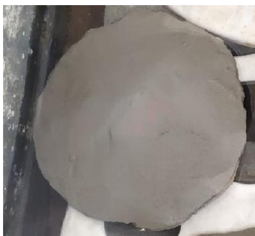
Рисунок 1. Испытание золы на равномерность изменения объёма (разработано авторами)
