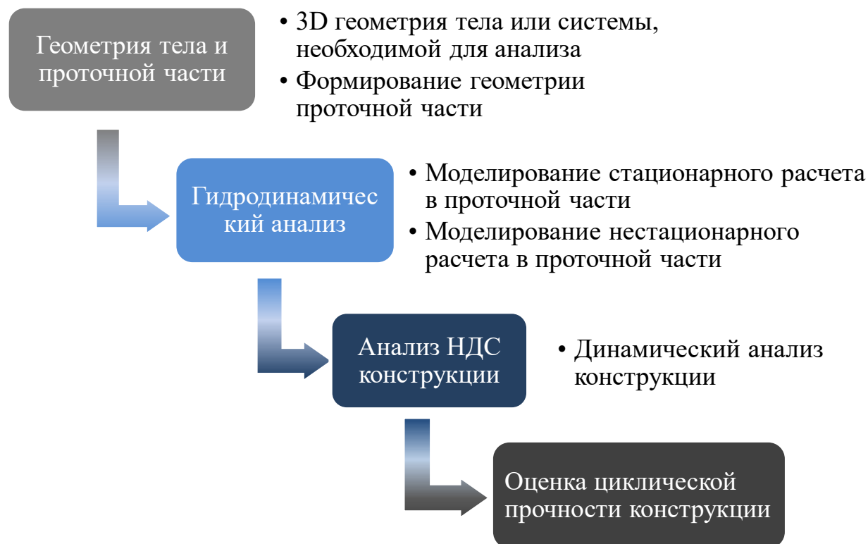
Рисунок 1. Этапы сопряженного анализа FSI (Fluid-Structure Interaction) (составлено авторами)
